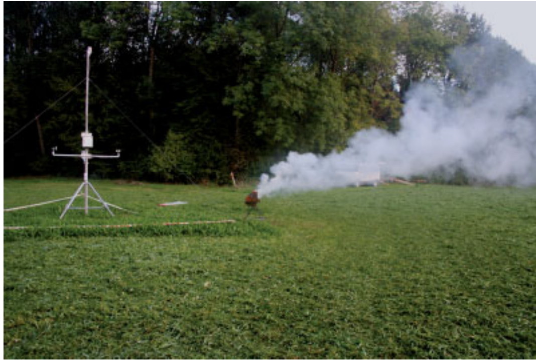
Rauchfahne nach Sonnenuntergang: im Baidter Ortsteil Friesenhäusle werden Windbewegungen untersucht
